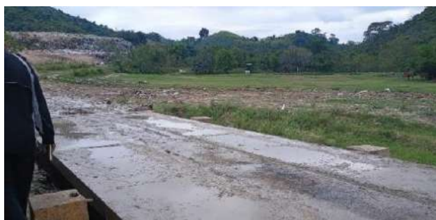
Báscula para el pesaje de los camiones recolectores
